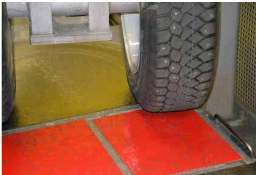
Detalj vid provning av Scuffing resistance med dubbdäck.
