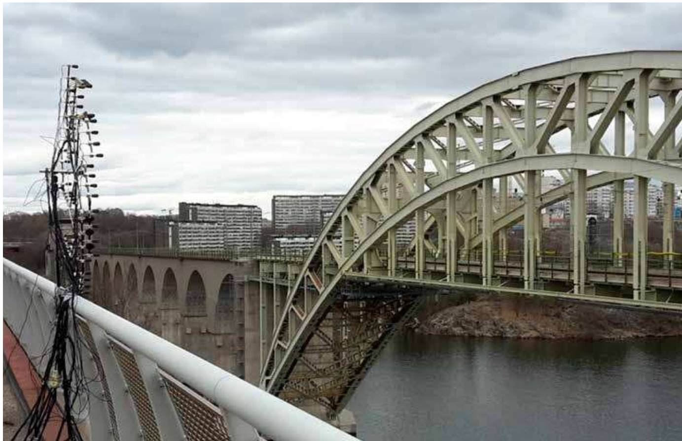
Bild 3. Ljudmätning från grannbro med akustisk kamera.
