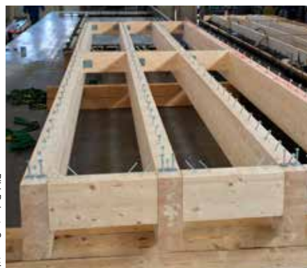
Figur 1. Ett prefabricerat samverkansbjälklag i trä och betong som laboratorietestades vid Lunds Universitet, 2015.
