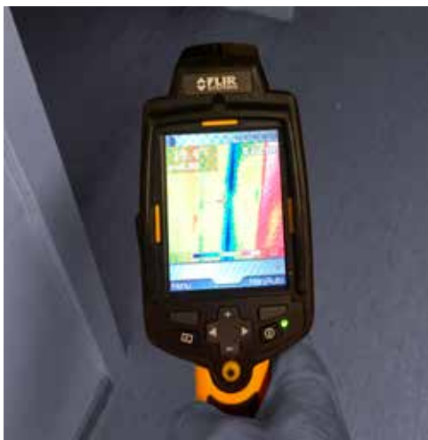
Figur 5. Termograferingsutrustning vid läckagesökning.
