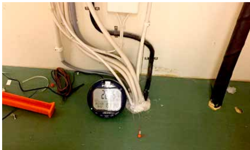
Figur 7. Otätheter kring ledningar lokaliserar med hjälp av spårgasmätning, i detta fallet koldioxid.
