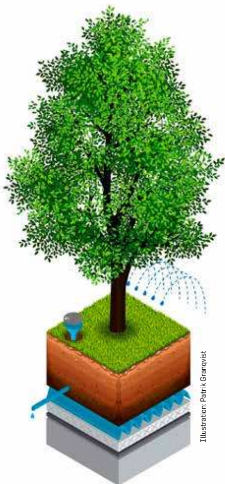
Figur 2. Överbyggnad på bjälklag kan delas in i vegetation, växtbädd, bevattning, dränering, avvattning och rotskydd.
