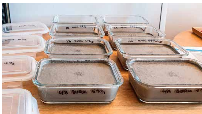
Figur 6. Gjutna burkar med avjämningsmassa.
